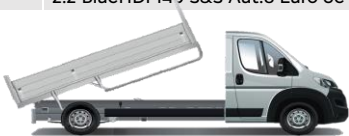
L3 DRIEZIJDIGE ACHTERWAARTSE KIPPER - Binnenafmetingen : L 3660 mm x B 2000 mm (met toolbox L 3010 mm)
